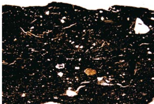
Ryc. 4. Fragment wewnętrznej powierzchni. Zadzioiry i wgłębienia powtarzają się (nie jest to rezultat korozji lecz sposobu wykończania powierzchni). Blaszkki biotyту (tutaj wielkości 0,2 mm) nadają migotliwość powierzchni. Tekstura części przypowierzchniowej masy ceramicznej jest falista. Pow. 25 razy, polaryzatory równoległe
